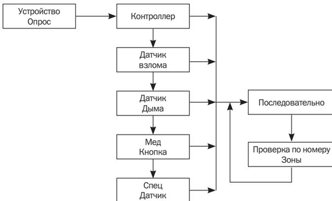
**Пример 1:** Для просмотра состояния контроллера по номеру зоны 01–01 введите пароль и перейдите к режиму **Тест Системы или Горяч. Кнопка** и выберите **\Устройство Опрос?\Контроллер\Пров по нр Зоны?** После этого укажите номер зоны **01–01** и нажмите кнопку подтверждения.
