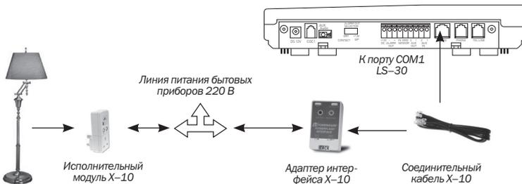
Адаптер X-10 и GSM модуль могут быть подключены одновременно, для этого необходимо использовать специальный кабель COM2 (приобретается отдельно).
